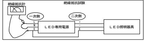
※LED専用電源一次側にて、DC500Vメガで両極一括と対地間を測定してください。二次側に試験を行う場合は、LED専用電源とLED照明器具を切り離し、LED照明器具側の+極一括と対地間
